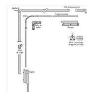
Profils de recouvrement pour ferme-imposte extra-plat Ventus F 200 longueur 3300 mm
